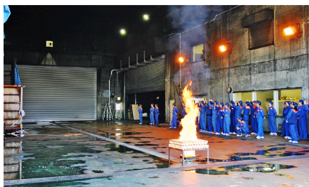
能美防災メヌマ工場（放水型スプリンクラー設備消火実験）
